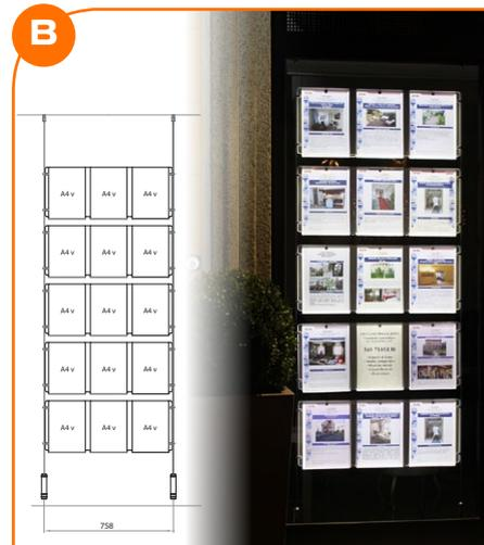
**Modulo completo di nr. 5 tasche piatte triple A4 verticale** retroilluminate a **LED**, con kit di fissaggio e alimentatore
